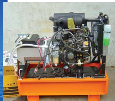
АДС 10 - 230 РЯ работает в условиях крайнего севера (полуостров Ямал) на супервездеходе "Витязь" в составе трех электроагрегатов
