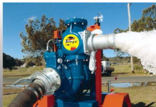
Большие самозаполняющиеся мотопомпы с дизельными двигателями Deutz. Патрубки 100- 300 мм, подача до 1400 м³/час, диаметр твердых фракций до 90 мм.
