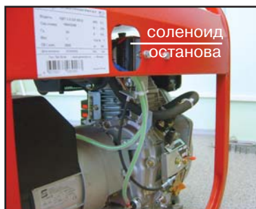
Защитное отключение при минимальном давлении масла
