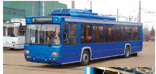
Первый в России троллейбус Башкирского троллейбусного завода с возможностью автономного движения без внешней электрической сети
