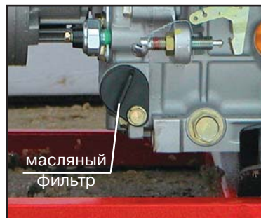
Защитное отключение при минимальном давлении масла
