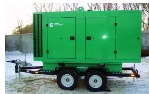
Шумозащитный кожух Cummins в мобильном исполнении, на шасси-прицепе.
