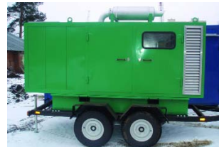
Шумозащитный кожух собственного производства НойХаус Групп в мобильном исполнении, на шасси-прицепе.
