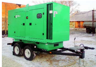
ДГУ в шумозащитном кожухе производства Cummins, установленный на шасси-прицепе.
